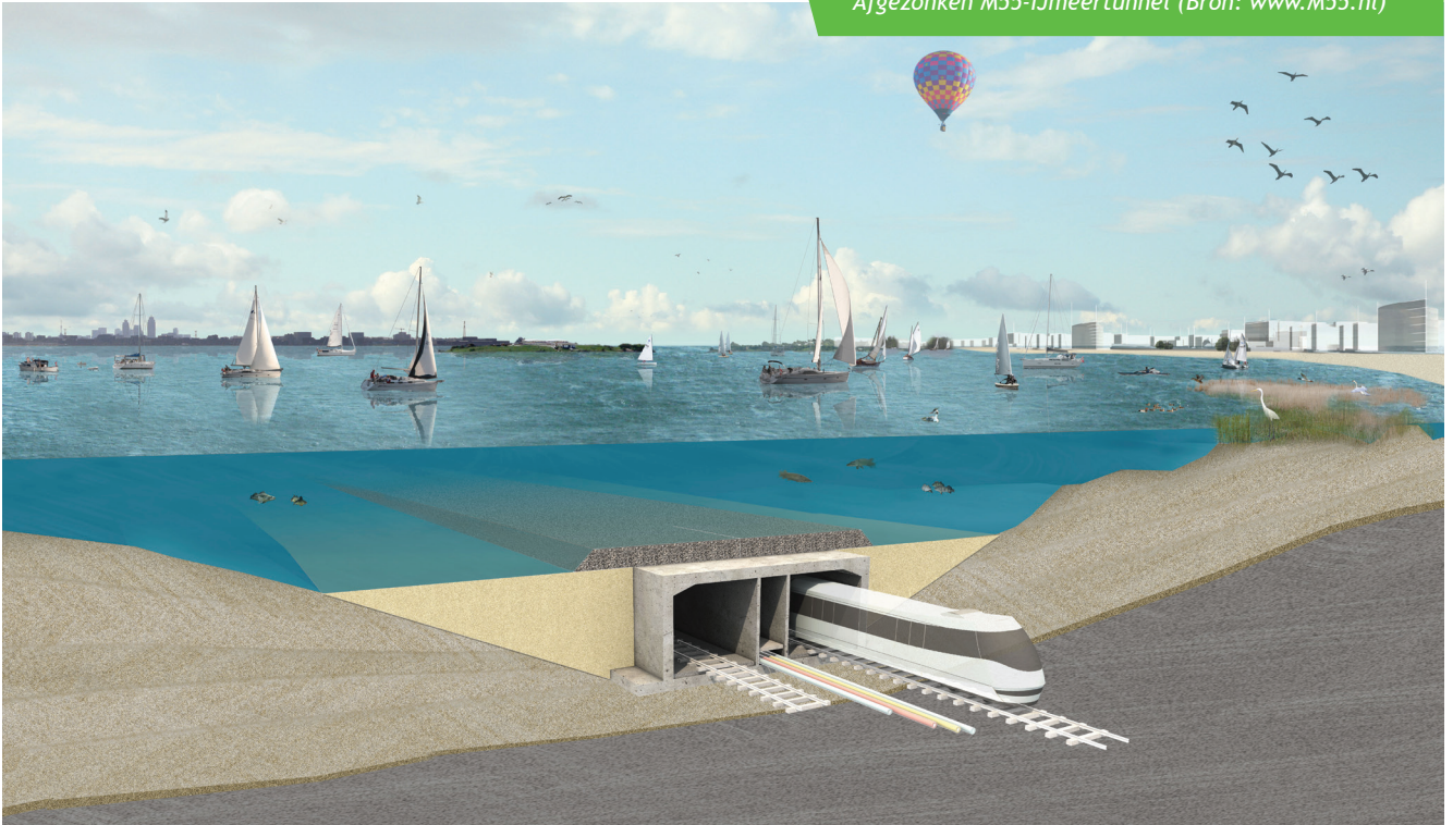
Afgezonken M55-IJmeertunnel (Bron: www.M55.nl )
